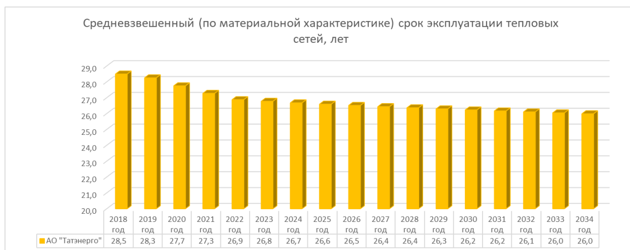
Рис. 14.2. Средневзвешенный (по материальной характеристике) срок эксплуатации тепловых сетей
